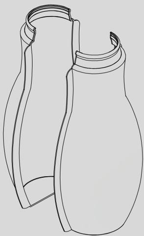
Dos partes iguales, un mismo molde de metal. Proceso de prensado
