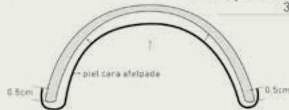
1-Se encola el forro a la parte interior del molde, haciendo que sobresalga 0.5 cm hacia la cara exterior. (colocar previamente la etiqueta en una de las caras.)
