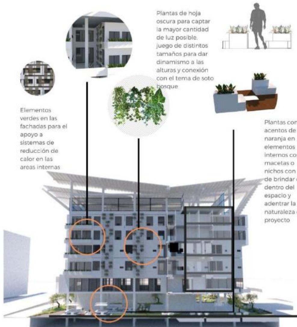
SECCIÓN DE MURO - PARED VERDE Y BALCÓN
